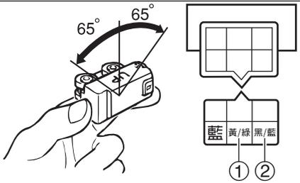
4. 當旋轉轉倒感知器約65°時，電壓讀取從0.4V~4.4V之間。<br>5. 轉倒感知器正常嗎？ |       |                                   |
