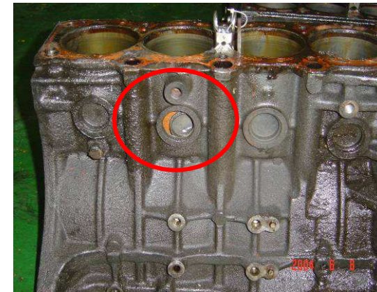
破壞完成之水套孔
