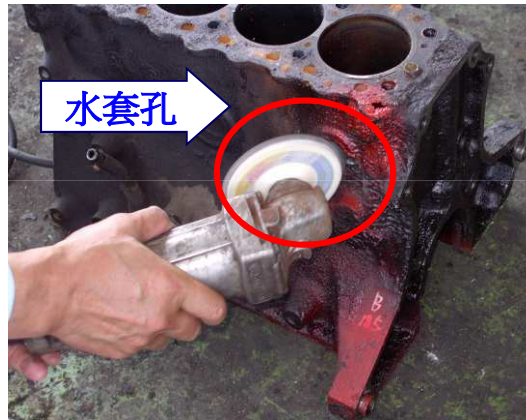
破壞水套孔(砂輪機)
