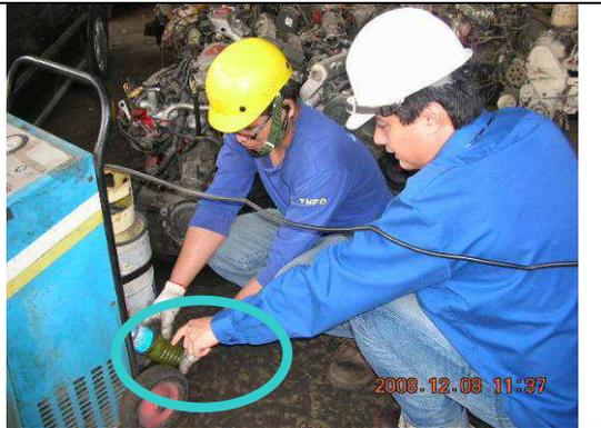
冷凍油貯存桶洩油作業
