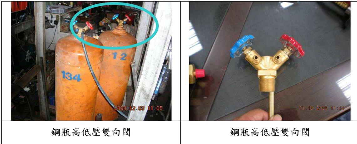
4. 檢查回收專用鋼瓶是否有銹蝕或凹陷等狀況，且新舊冷媒是否有標示 R-12 及 R-134a 之字樣，並分開回收作業。
